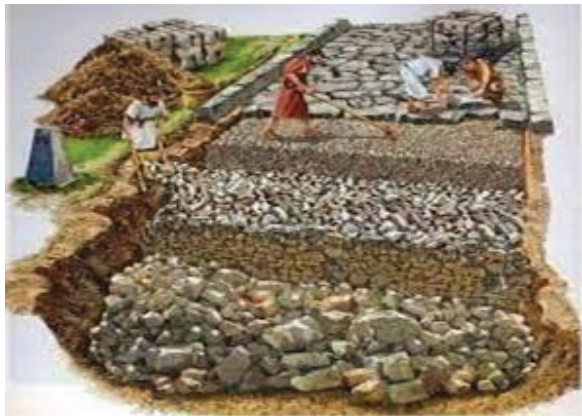
Izgradnja Rimskog puta
